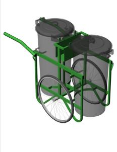
PB200FE struttura in acciaio elettro saldata verniciata, manici smontabili per ridurre costi di spedizione ruote semipiene montate su doppio cuscinetto a sfere Ø 24″x 1 3/8 con raggi mm 2 alloggiamento per paletta e scopa, bidoni in polietilene da litri 100 con coperchio incernierato dimensioni d'ingombro mm. largh. 620 prof. 1520 altezza mm 1095 volume per spedizione compreso due bidoni m³ 0,70
